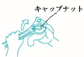
4. キャップナットを締め元に戻します。キャップナットを強く締めるとハンドルが固くなるので締め過ぎに注意して下さい
